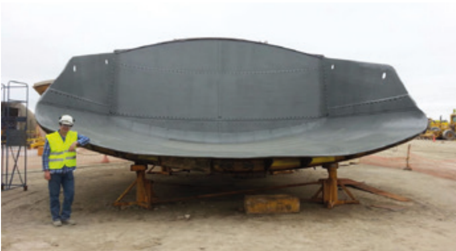
Revestimiento de camiones mineros de sobrecarga.
